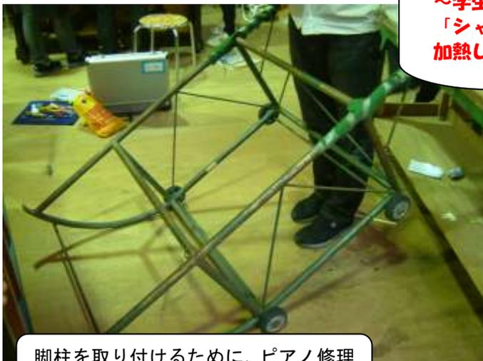
脚柱を取り付けるために、ピアノ修理台を使ってピアノを横にします。
