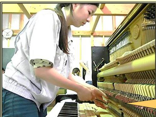
正常な動きと、演奏性を高めるため、鍵盤の動きを無駄なく伝えるように各部の位置を調整しています。
