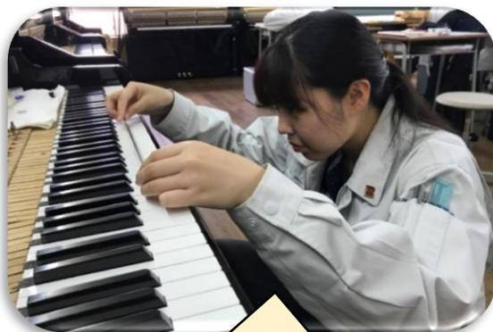
定規が当たる範囲の両端の鍵盤を基準寸法通りの高さにします。
