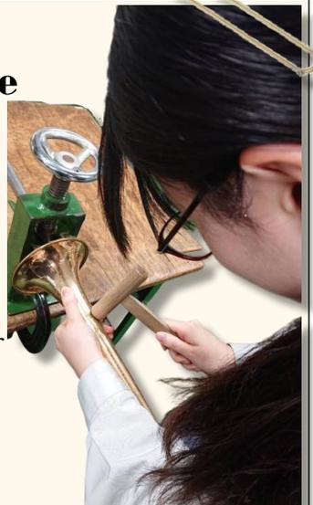
ぶついたり、落としたりしたときに生じた凹みを直す実習です。こする・叩くなどの方法で凹みを出していきます。素材の違うハンマーを使い分けたり、叩く強さを変えたりと、自分で工夫しながら作業をする必要があります！
