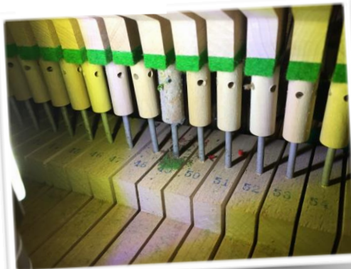
↑緑色の粉が付着しワイヤーが錆びています。
