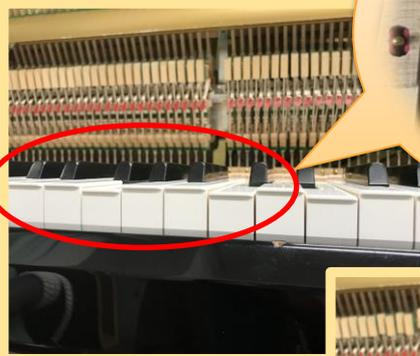
鍵盤の高さのズレを1mm以下のとても薄い紙を使って調整します。
