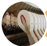
ピアノは鍵盤を叩くことで、指の動きがハンマーに伝えられ、連動したハンマーが弦を叩き、反響させ発音します。
