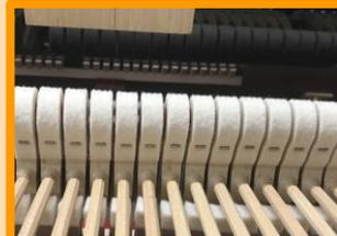
写真で触っているネジを上下させてハンマーの位置を動かし、高さを揃えます。
