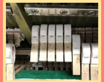
写真で触っている部品(バックチェック)を前後させて調整します。
