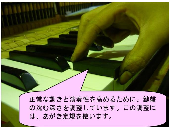
正常な動きと演奏性を高めるために、鍵盤の沈む深さを調整しています。この調整には、あがき定規を使います。
